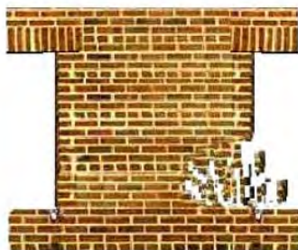
(د) مود شکست بر اثر فشار در پنجه
