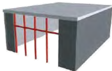
الف- اضافه کردن دیوارهای سازه‌ای
